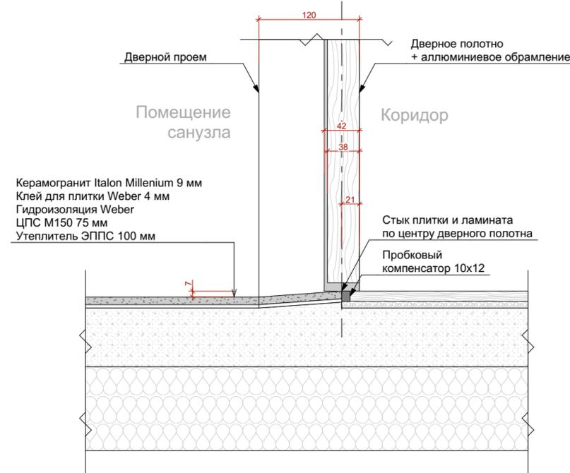
**! В санузлах гидроизоляционную мастику наносить в 2 слоя с гидроизоляционной лентой. Завести на стены на 200 мм**
